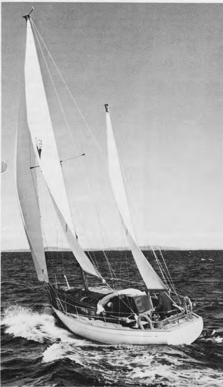
Rumpf und Deck unserer VINDÖ-Kreuzer sind aus GFK; ist mit Teakstab belegt und mit Gummi ausgegossen. Der Bleiballast ist vorgeformt und mit Kunststoff fest eingesetzt. Alle Auf- und Einbauten sind aus erstklassigem Mahagoni und Teakholz. Masten und Bäume sind aus Aluminium; das gesamte Rigg aus Nirosta. Die Segel sind aus hochwertigem Dacron. Alle VINDÖ 50-Typen liefern wir auf Wunsch mit Besan. Aus Foto und Zeichnung ersehen Sie die Anordnung.
