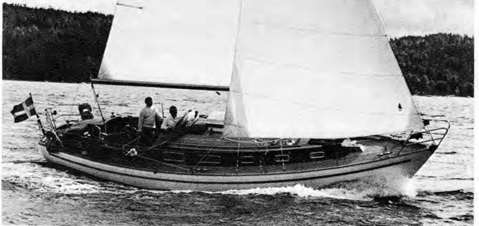
Detta är VINDÖ 50 SL. Genomgående kvalitet, snabb, elegant och sjövärdig. En båt för den kräsne seglaren. Skrov och däck är av glasfiber, däck försett med ett teakdäck lagt av massiv teak. Trädetaljerna av förstklassigt teak och mahogny. Mast och bom av aluminium, riggen av rostfritt. Allt är genomtänkt. En båt som ger Er förtroende.
